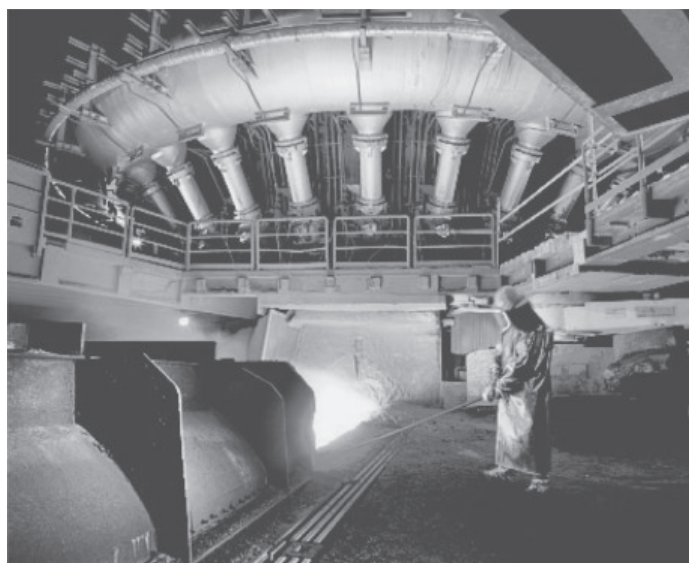
Fig. 2.4 Furra e Simens – Martinovit për përfitimin e çelikut
