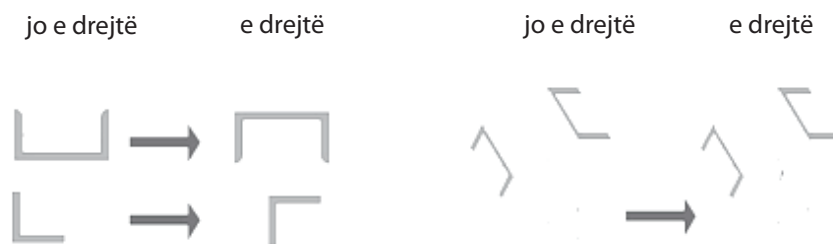
Fig. 4.36 Vendosja e elementeve në konstrukcione
